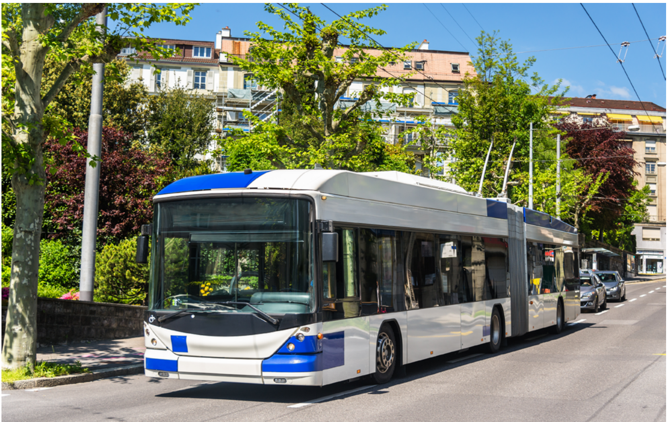
O-Busse, die sowohl im Oberleitungs- als auch im Batteriebetrieb fahren können, kommen immer häufiger zum Einsatz.
